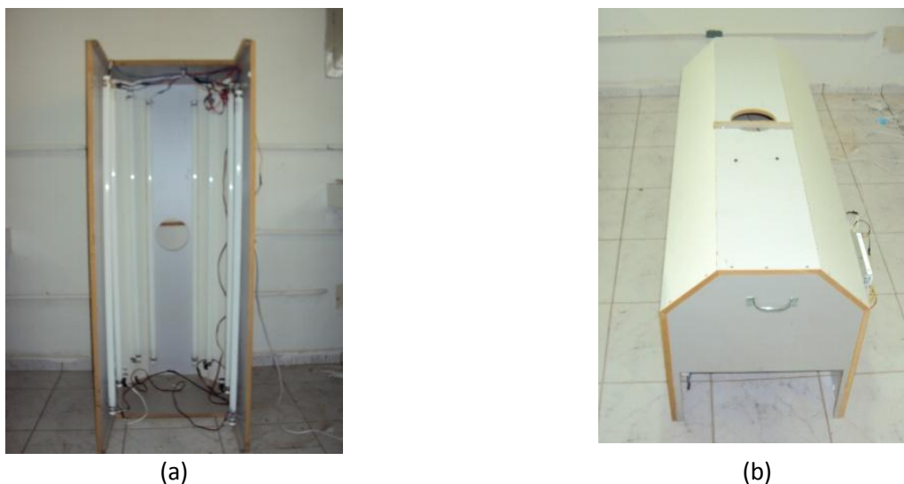
Figura 1. Câmara de luz uniforme utilizada na obtenção das imagens, vista interna (a) e vista externa (b)
